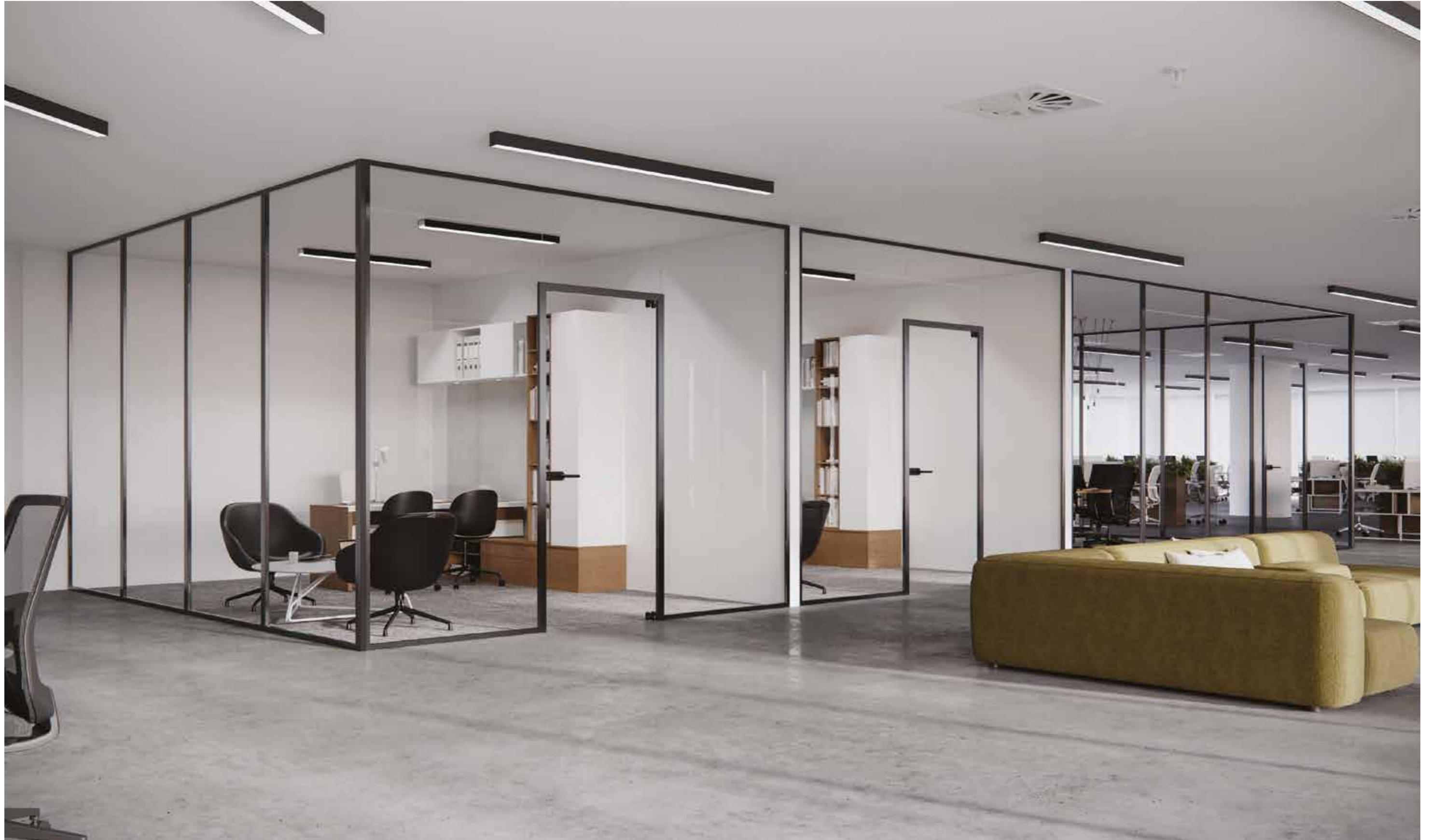
INSTALACIÓN SELEC CON PERFILES ESQUINEROS A 90° Y PERFILES EN "T" PARA LA UNIÓN DE PANELES FIJOS DE VIDRIO. SISTEMA DE PERNIOS PIVOTANTES. COLOR 21 SELEC INSTALLATION WITH 90° CORNER PROFILES AND "T" PROFILES AS JOINING FIXED GLASS PANELS. PIVOTING HINGES SYSTEM. COLOR 21
